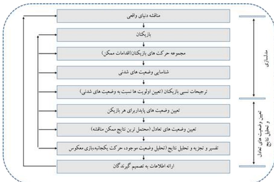
شکل ۱. فرایند مدل‌سازی و تجزیه و تحلیل در مدل‌های گراف
